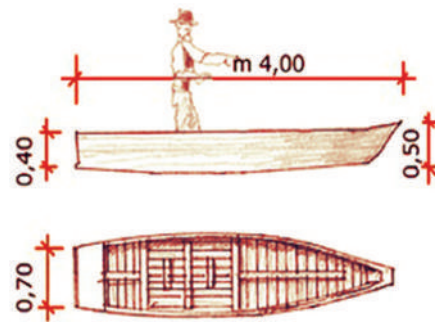
Fig. 1. Barchino, in uso esclusivamente lungo la riva. Disegno di E. Pasquali di Passignano.
